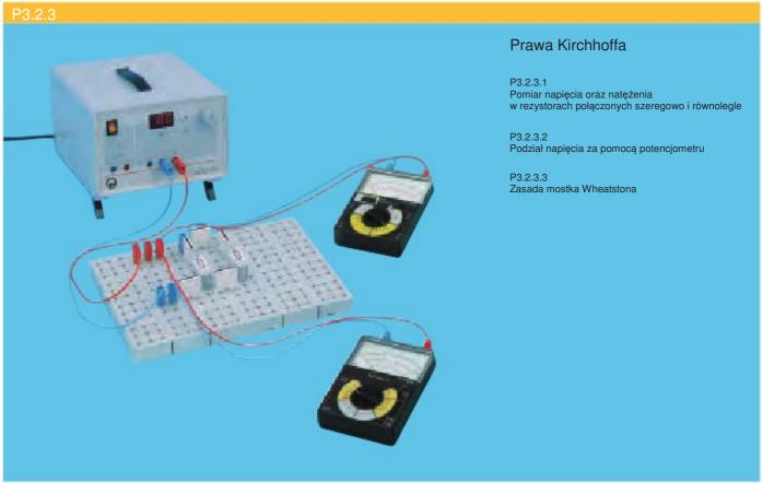
Pomiar napięcia oraz natężenia w rezystorach połączonych szeregowo i równolegle (P3.2.3.1)
