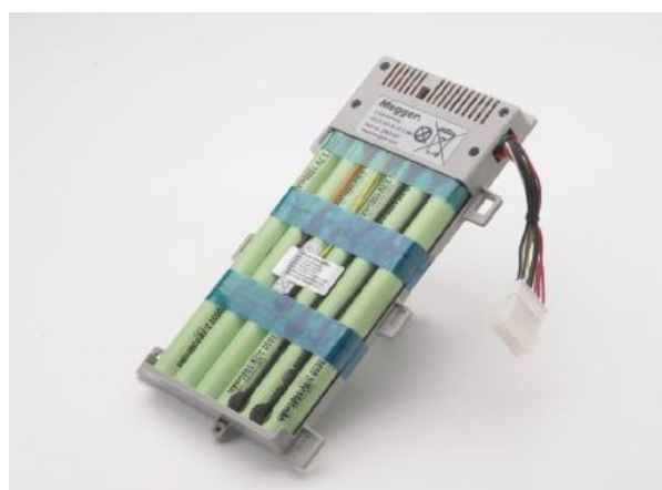
Wymieniany przez użytkownika lekki pakiet akumulatorowy Li-ion umożliwia wykonanie – przy pełnej pojemności akumulatora – 200 pomiarów ręcznych lub automatycznych prądem 100A lub dwóch dziesięciominutowych pomiarów ciągłym prądem 100A. Czas ładowania – 2,5 godziny od rozładowania do pełnej pojemności.
