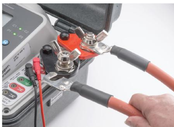
Nowy typ adaptera do gniazd miernika pozwalający na użycie niestandardowych przewodów pomiarowych.
