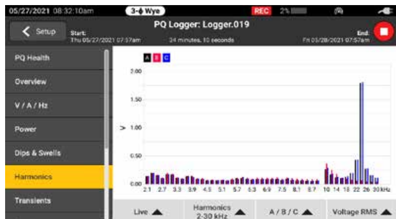
Pełny zakres harmonicznym jest dostępny od pierwszych 50 harmonicznym całkowitych oraz od 2 kHz do 30 kHz
