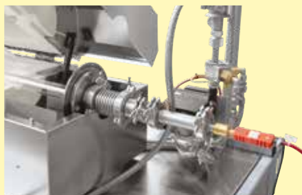
Gazoszczelne złącze obrotowe z chłodziwą gazu i termometrem do pomiaru temperatury wsadu
