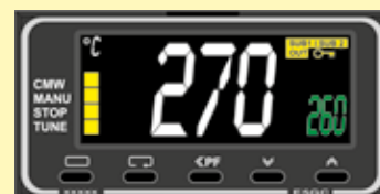
Przykład nastawnego ogranicznika temperatury
