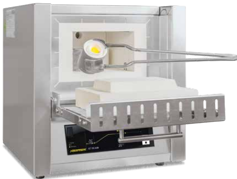
Piec mufkowy L 3/11 z drzwiami uchylnymi
