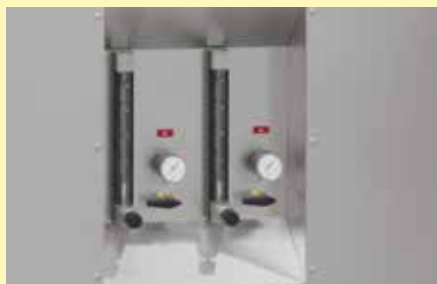
Automatyczny system zasilania gazem osłonowym
