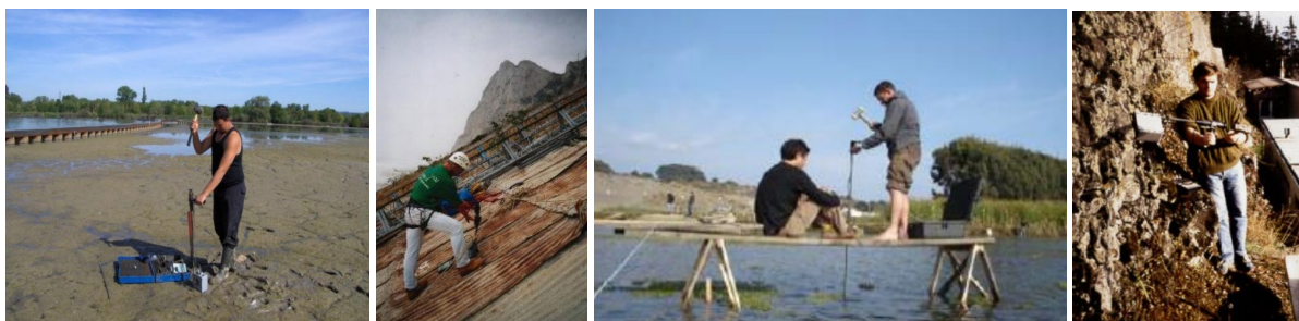
Rys. 1 Przykłady zastosowania penetrometru PANDA w miejscach trudnodostępnych
