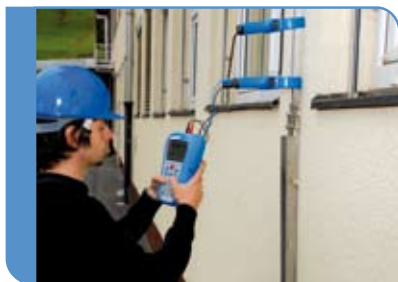
Metoda dwu cęgowa do pomiarów rezystancji uziemienia obiektów w układach TN
